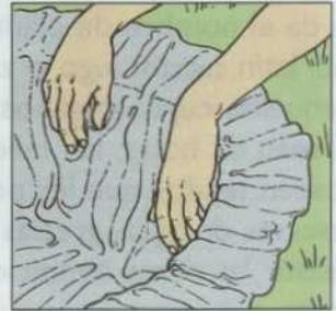
**2** La cavidad se reviste con una lámina de polietileno resistente o PVC.
