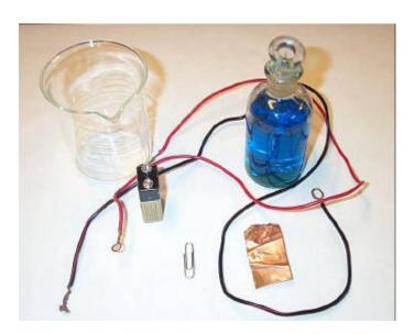
Figura 1. Materiales necesarios: pila, cables, objeto a recubrir, lámina de cobre, vaso de precipitados y disolución 1,0 M de sulfato de cobre, CuSO<sub>4</sub>.
