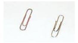
Figura 4. Resultado de la electrodeposición.
