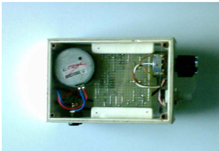
Fig. 6 Vista posteriore del controllo di velocità di un motore in corrente continua con logica PWM.
