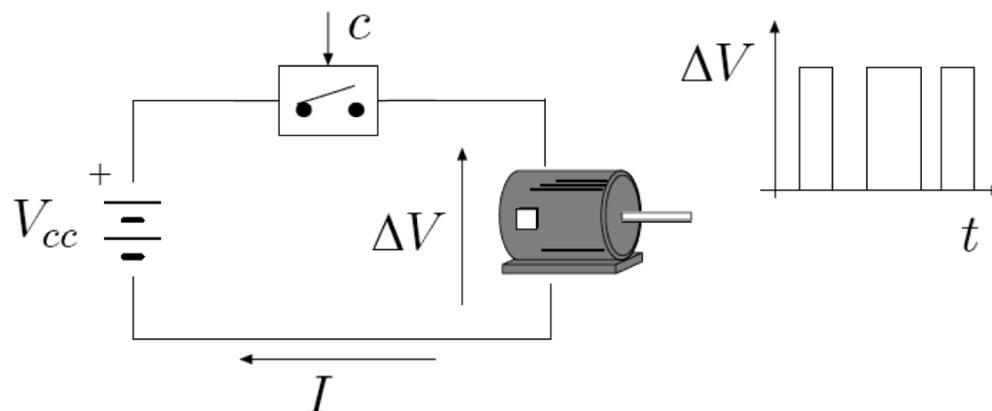
**idea** se la frequenza è abbastanza elevata (KHz) la corrente media nell'induttore diventa costante e proporzionale al duty cycle del segnale
