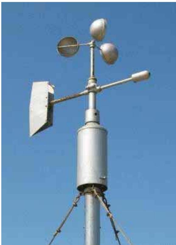
Hay varios instrumentos para medir y registrar la dirección y velocidad del viento en superficie, en general conocidos como anemómetros y anemógrafos. El anemómetro utilizado con más frecuencia es el rotativo de cazoletas o cubetas (Ver Fig. 2-4), el cual normalmente consta de
