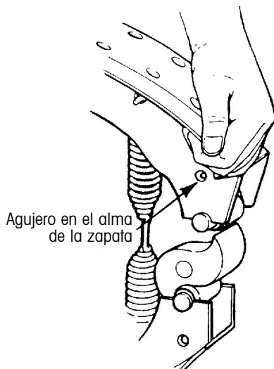
Figura 32. Colocando el nuevo resorte de retorno de frenos
