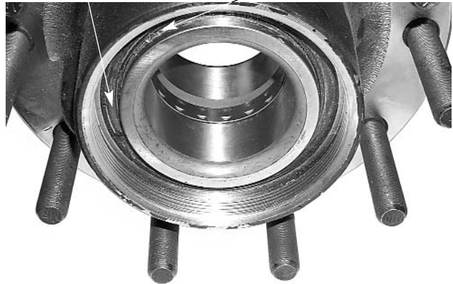
Figura 67. Grasa normalmente presente en el sello externo de la maza
