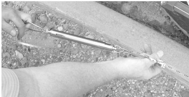
Figura 18. Usando la herramienta tensora de la cinta
