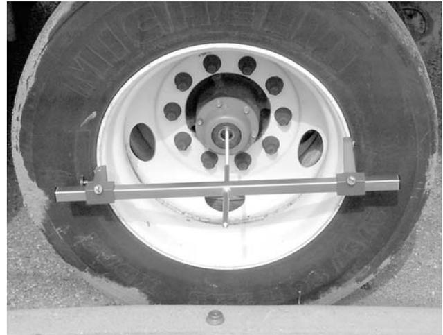
Figura 16. Extensión de terminal de la rueda instalada
