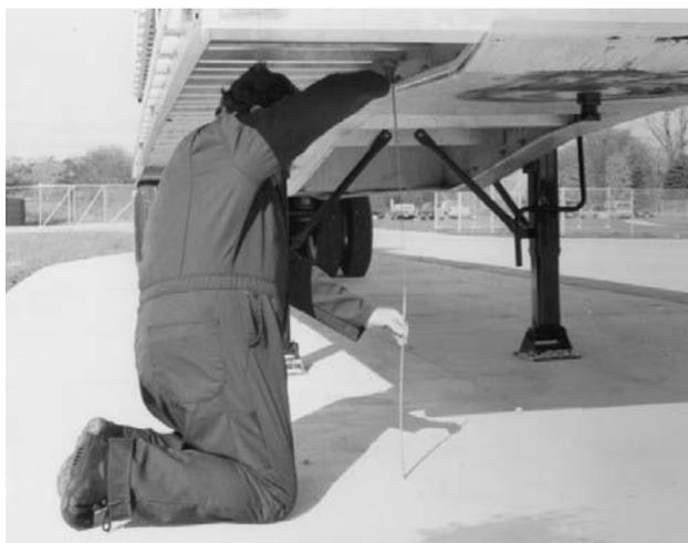
Figura 12. Midiendo la altura actual del perno rey
