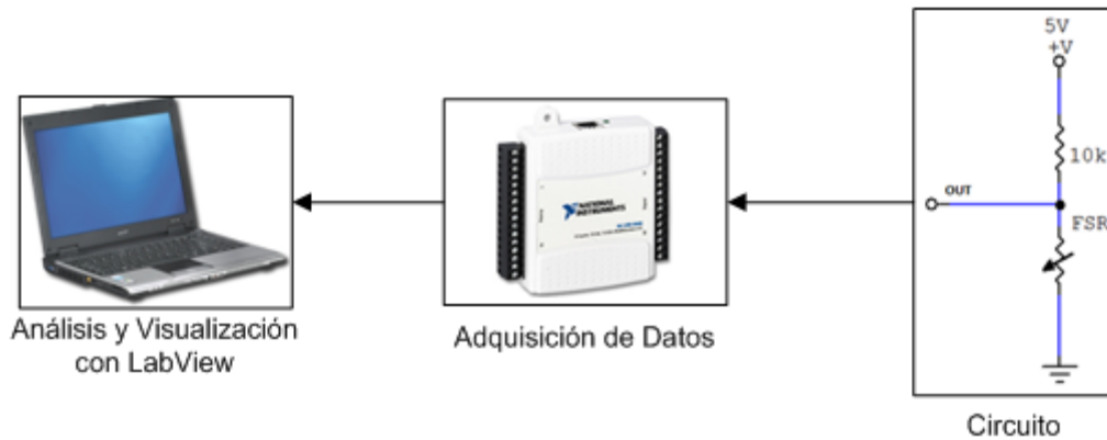
Figura 5. Esquema de Adquisición de Datos y Visualización.
