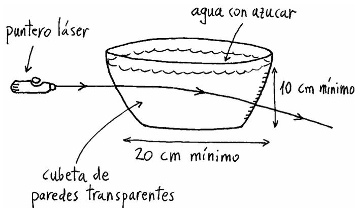
Figura 2. Dispositivo para el estudio de la trayectoria de la luz en disolución de azúcar en agua.
