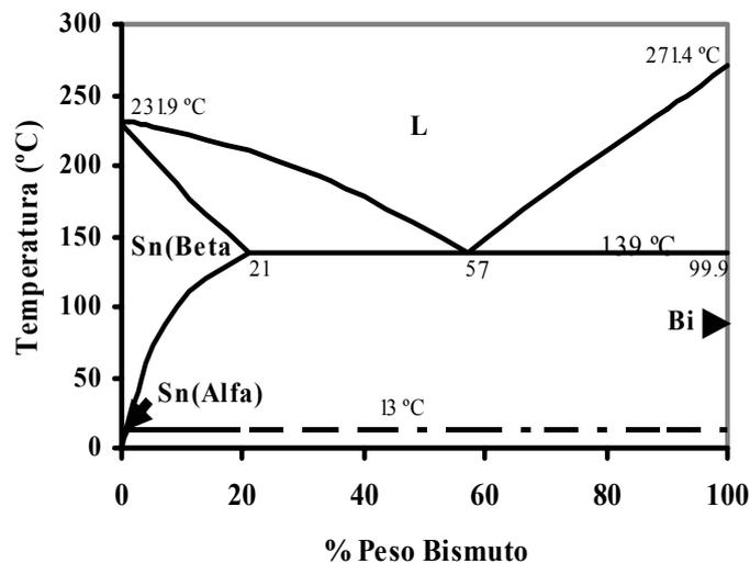
Figura 1. Diagrama de fases del sistema Sn-Bi.
