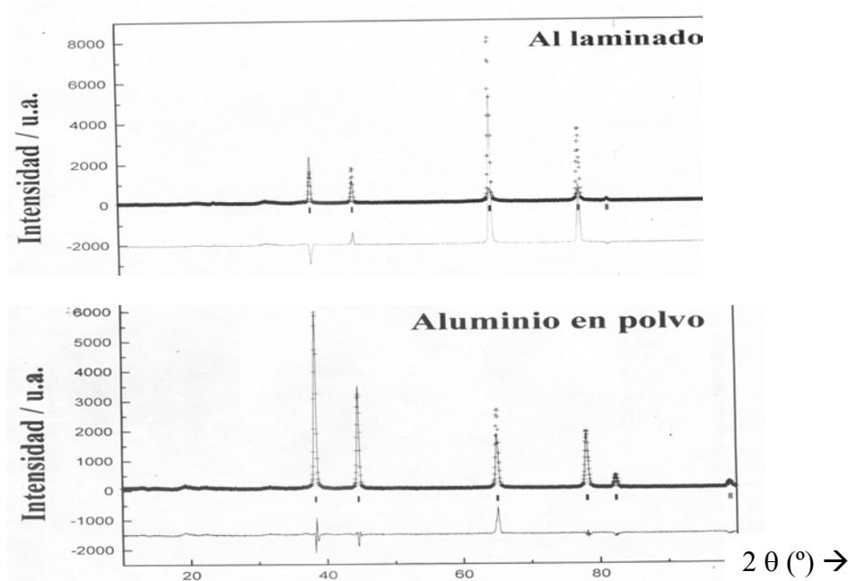
Figura 4. Espectro de rayos X del aluminio en dos condiciones diferentes.
