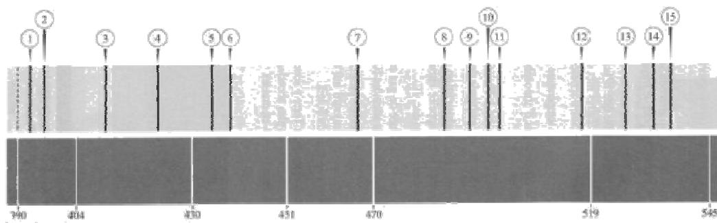
*Figura 2: La parte superior proporciona parte del espectro visible del Sol, donde las principales líneas de absorción aparecen numeradas y subrayadas como líneas oscuras. La de abajo es parte del espectro de emisión del Ar, que sirve de referencia para determinar las longitudes de onda correspondientes.*
