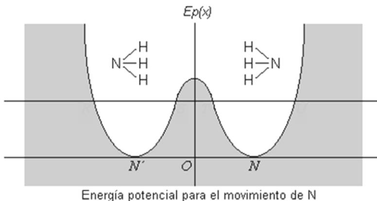
Figura 3. Barrera de potencial para el N en la molécula  $\text{NH}_3$ .
