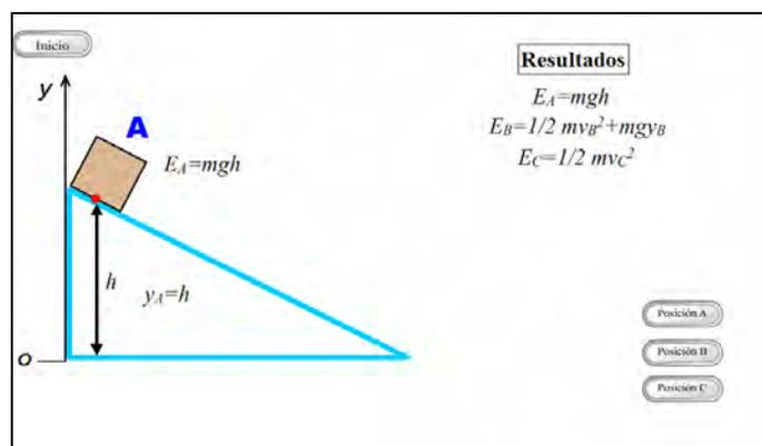
Figura 4. Animación Flash para ilustrar el método de conservación de la energía aplicado a la resolución de problemas de Dinámica.
