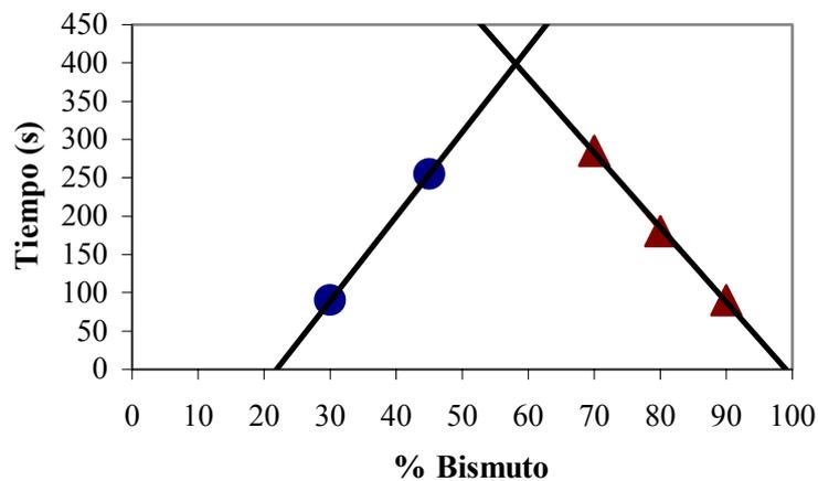
Figura 3. Triángulo de Tamman para las aleaciones del sistema Sn-Bi ensayadas.
