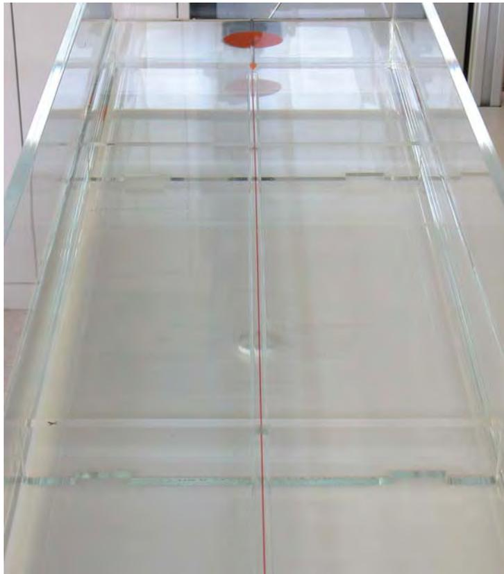
*Figura 2. Flujo laminar en un tubo de sección circular. El colorante inyectado en la sección de entrada genera una línea continua a lo largo del tubo.*
