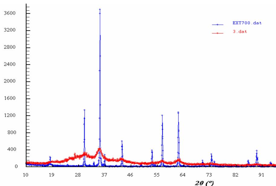
Figura 7. Espectros superpuestos de ferrita y nanoferrita.
