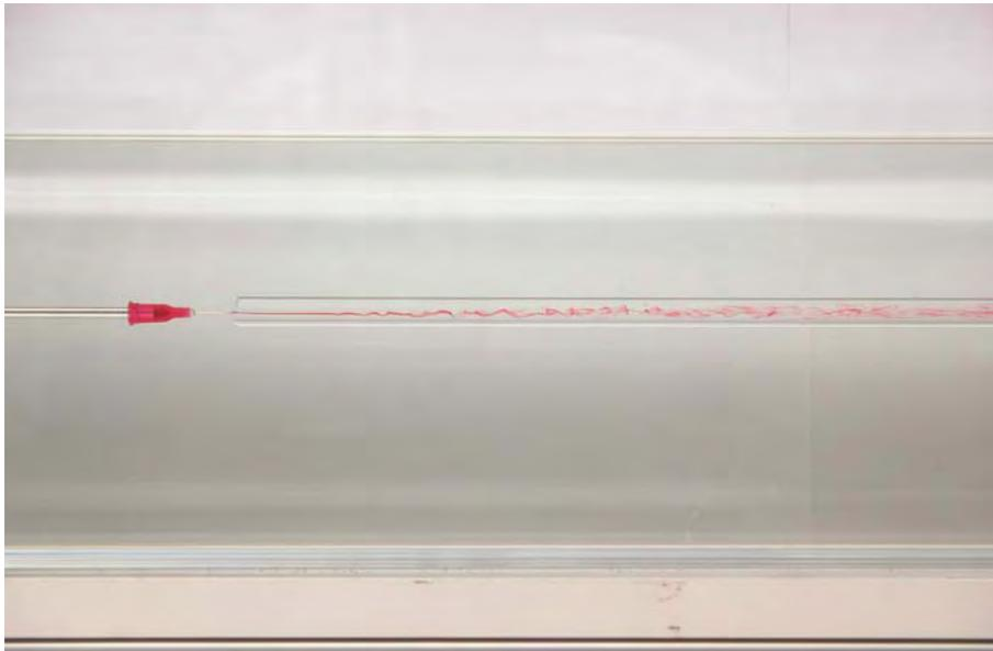
*Figura 4. Transición a turbulencia para  $Re=2000$ .*
