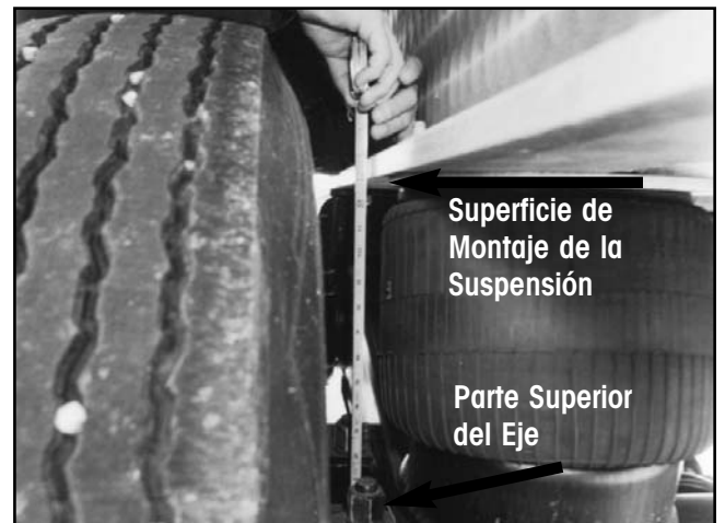
Figura 7. Mida la altura de manejo
