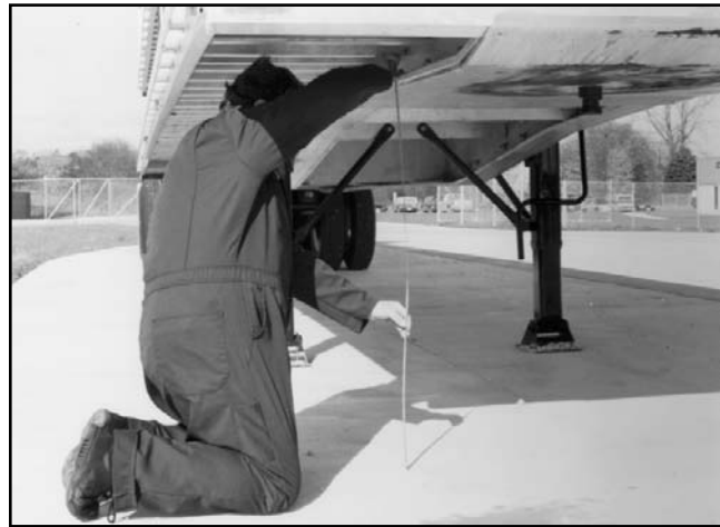
Figura 5. Mida del piso a la placa del perno rey
