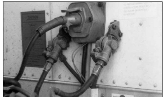
Figura 3. Mantenga la presión de aire en la suspensión
