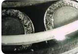
Desgaste del extremo del rodillo causado por excesivo apriete, degradación del lubricante, o falta del mismo.
