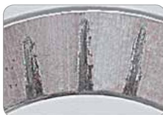
Apariencia típica de una superficie con efectos repetidos de vibración (llamado "falsa brinelación").
