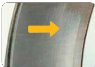
Desgaste de deslizamiento severo debido a presencia de abrasivos.
