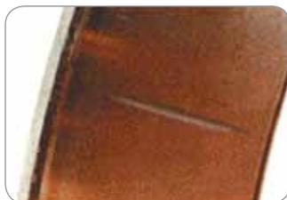
Melladura a través del aro de rodadura que indica un golpe agudo.
