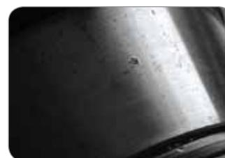
Apariencia de la superficie por arco eléctrico durante soldadura.
