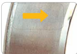
Bollos y melladuras en las superficies del rodamiento indican que se usó un punzón durante la instalación.
