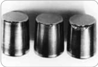
Fractura de los bordes del rodillo debido a altos picos de carga causados por exceso de huelgo o un ajuste del rodamiento flojo.
