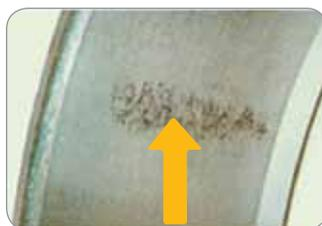
Ataque químico del metal que indica generalmente contaminación con agua, permitiendo la oxidación de la superficie.
