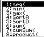
Por ejemplo, **List** presenta un submenú que permite seleccionar funciones específicas de List.
