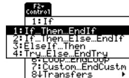
Al seleccionar una estructura como **If...Then...EndIf**, se inserta una plantilla en la posición del cursor.
