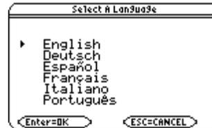
2. Pulse **[ENTER]** para que la TI-89 / TI-92 Plus incorpore el idioma seleccionado (si pulsa **[ESC]**, el proceso de cambio de idioma se detiene y aparece la pantalla Home).
