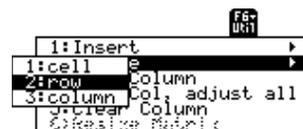
Al borrar una fila, las filas siguientes se desplazan hacia arriba. Si borra una columna, las columnas situadas a la derecha de ésta se desplazan hacia la izquierda.
