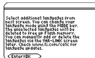
4. Pulse las teclas del cursor ( $\odot$  o  $\ominus$ ) para mover el puntero y después pulse **[F1]** para seleccionar los idiomas adicionales que quiera guardar.
