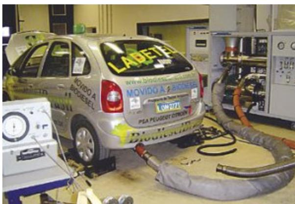
No Lactec, em Curitiba, testes de bancada para carro movido com 30% de biodiesel
