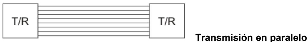
Ejemplo: La conexión de una impresora al puerto paralelo de un ordenador.
