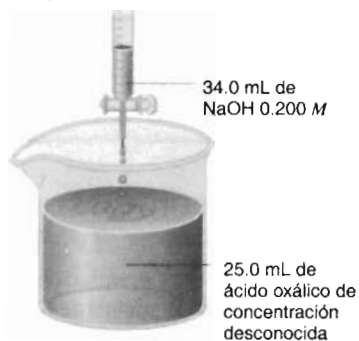
FIGURA 2.19 Adición de hidróxido de sodio a ácido oxálico, como en el ejercicio 2.15.
