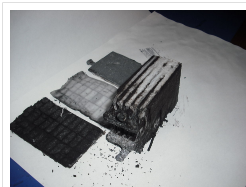
Batería de plomo-ácido con celdas de fieltro de vidrio absorbente, mostrando aparte los dos electrodos y, en medio, el material de vidrio absorbente que evita derrames del ácido.
