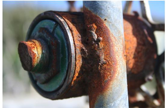
Corrosión del hierro - una reacción química con una velocidad de reacción *lenta*.
