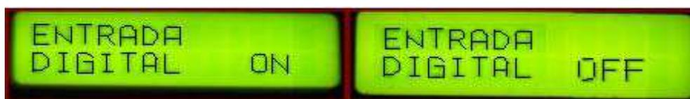
Figura 4..16 a) ENTRADA DIGITAL EN ESTADO ON      b) ENTRADA DIGITAL EN ESTADO OFF
