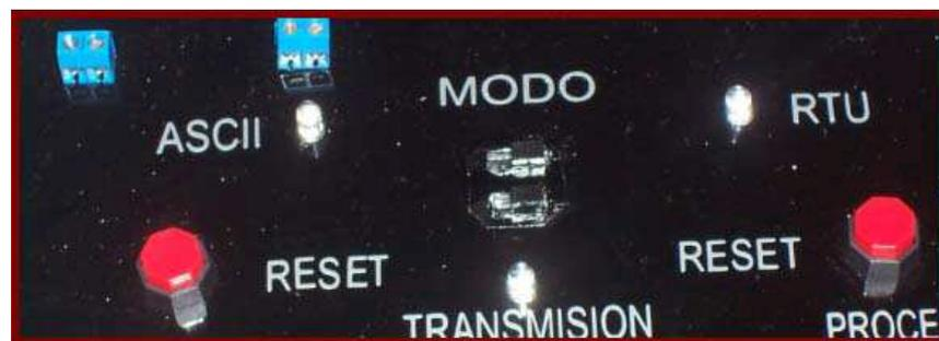
**Figura 3.16 LEDS DE MODO(modos)**
