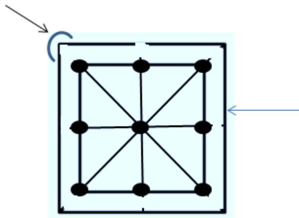
8. Volver a marcar los puntos con el granete y realizar los taladros (sin perforar el tablero) en los 9 puntos con una broca de 20 mm de diámetro.
