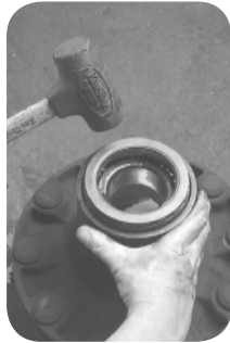
Se puede usar un martillo de caucho para golpear suavemente a su posición final.
