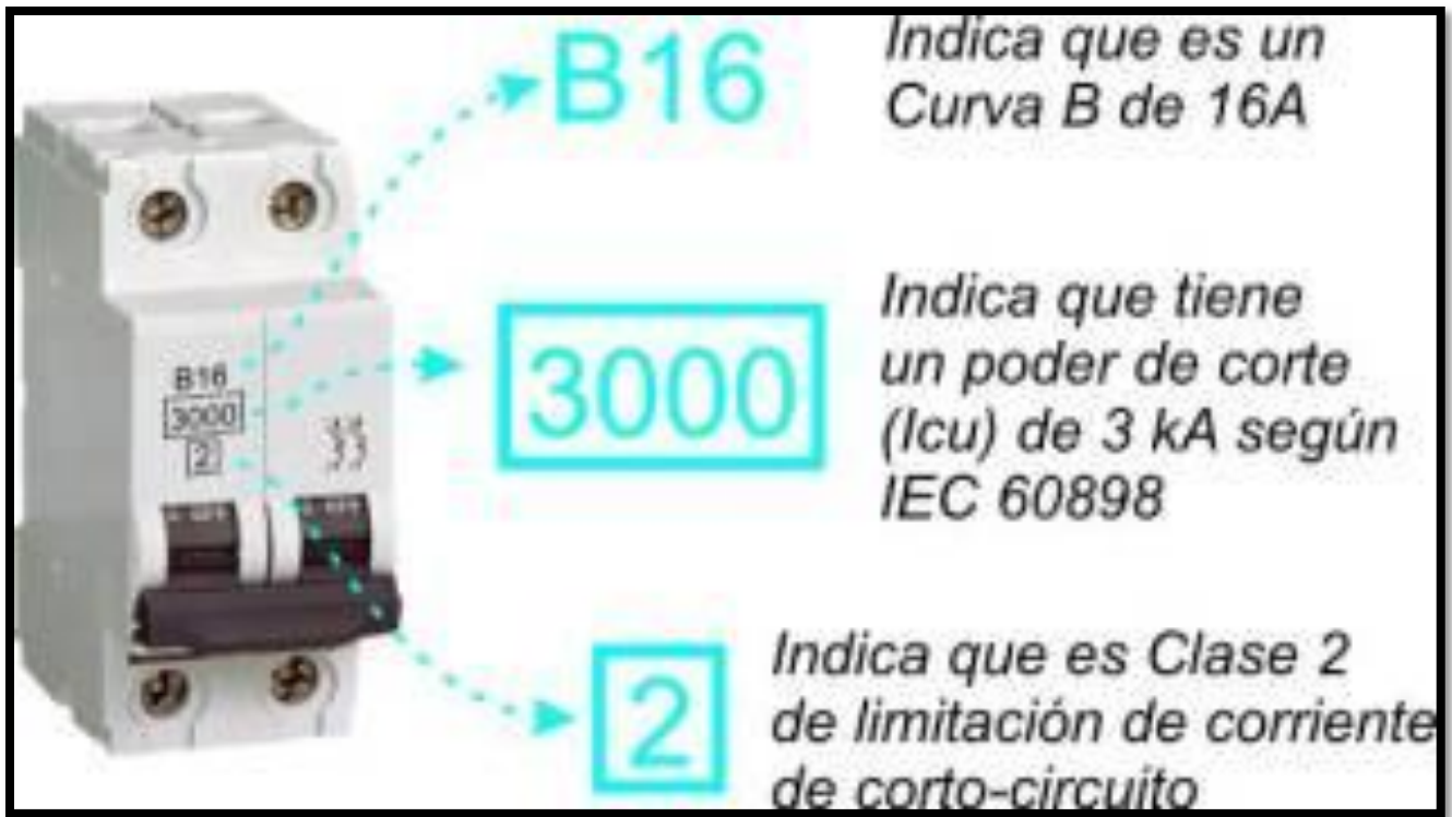
figura 4: frente de un interruptor de riel con identificaciones obligatorias (no están todas)
