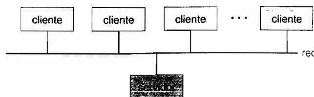
Figura 1.11 Estructura general de un sistema cliente-servidor.
