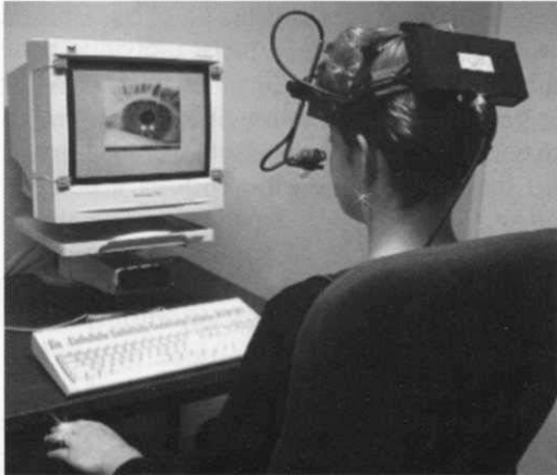
Figura 11-4. Seguimiento de los movimientos oculares. A través de un aparato especial ( eyetracker ) es posible seguir y registrar el movimiento de los ojos durante la lectura u otra tarea de exploración visual (imagen del Instituto Max Planck).
