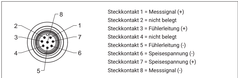
Abb. 5.1 Steckerbelegung
