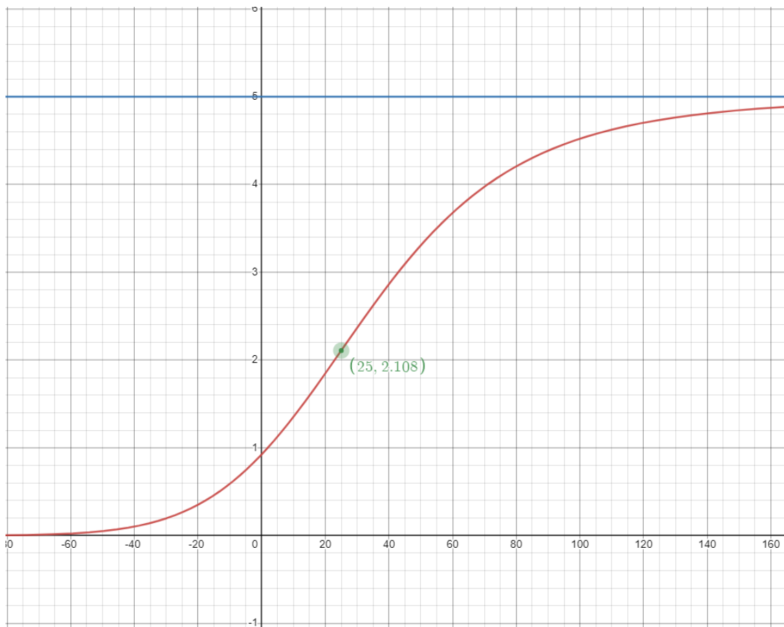
Fig. 2 Curva en S del divisor de tensión, apreciándose la linealización en el rango de temperaturas de 0 a 50°C.
