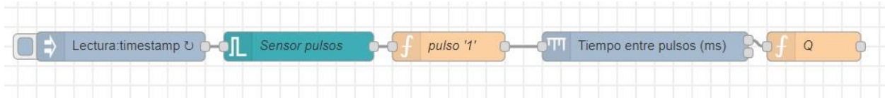
Figura 24 Flujo de Node-RED para medir el caudal
