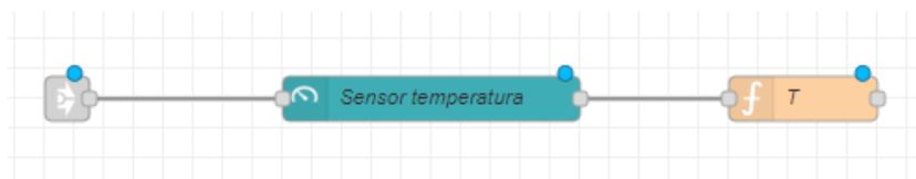
Figura 32 Flujo de Node-RED para la lectura del termistor
