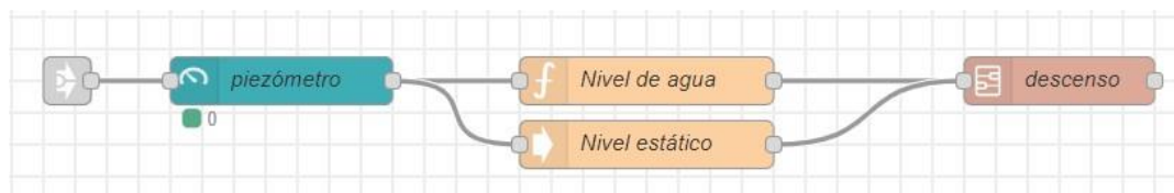
Figura 26 Flujo de Node-RED para la medición del nivel de agua
